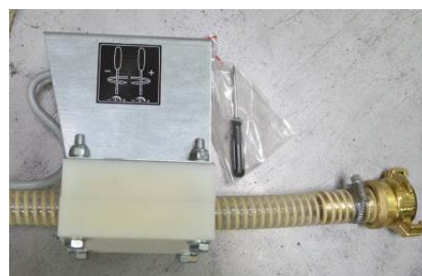
Alimentación del sensor de proximidad
